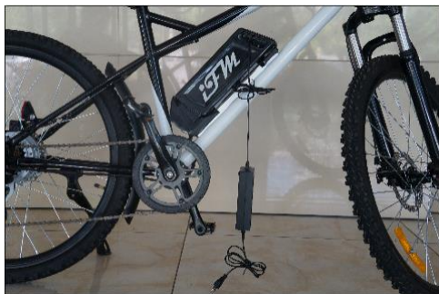
Figura 12 – Cavo del carica batterie collegato alla batteria d'alimentazione della bicicletta.
